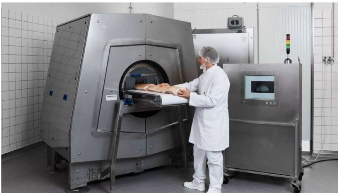
Slik ser CT-skanneren for næringsmiddelbruk ut. Modellen vil i prinsippet kunne skanne 600 midtstykker av svin hver time. (Bilde: Teknologisk Institut)
