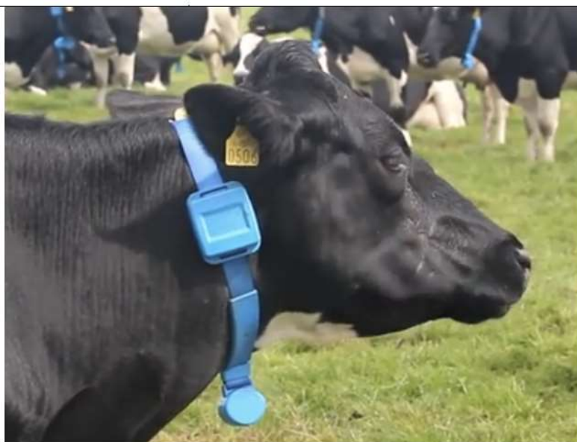
Figura 1 e 2 - Coleira e respetivo dispositivo com sensor incorporado.
